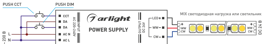
Рис. 2. Пример подключения функции PUSH DIM, PUSH CCT
