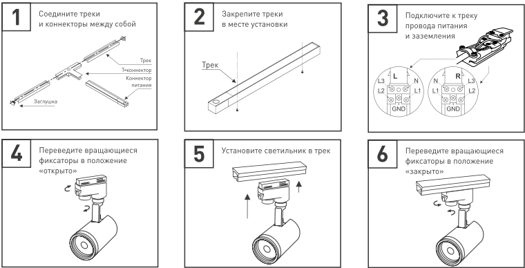
Рис. 2. Установка и подключение светильника
