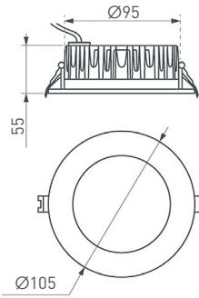
Встраиваемый круглый светильник, белый алюминиевый корпус. Цвет свечения БЕЛЫЙ ДНЕВНОЙ, св. поток 810 лм, CRI(Ra)>90, угол излучения 110°. IP44. Питание 230 В, мощность 9 Вт. Размеры: Ø105×55 мм
