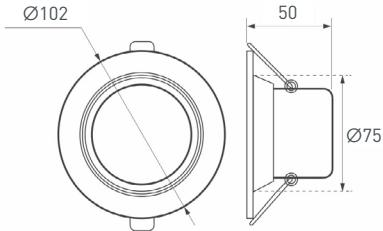
Встраиваемый круглый светильник, белый алюминиевый корпус. Цвет свечения БЕЛЫЙ ДНЕВНОЙ, св. поток 300 лм, CRI(Ra)>80, угол излучения 120°. IP40. Питание AC 230 В, мощность 5 Вт. Размеры: Ø102×50 мм.
