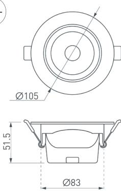
Встраиваемый поворотный светильник, белый алюминиевый корпус. Цвет свечения БЕЛЫЙ ДНЕВНОЙ 4000 К, св. поток 900 лм, CRI(Ra)>90, угол излучения 36°. IP20. Питание AC 230 В, мощность 10 Вт. Размеры: Ø105×51.5 мм.
