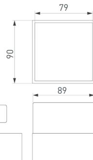
Встраиваемый светильник, черный алюминиевый корпус. Цвет свечения БЕЛЫЙ ДНЕВНОЙ 4000 К, св. поток 1226 лм, CRI(Ra)>90, угол излучения 90°. IP40. Питание AC 230 В, мощность 12 Вт. Размеры: 90×90×90 мм.
